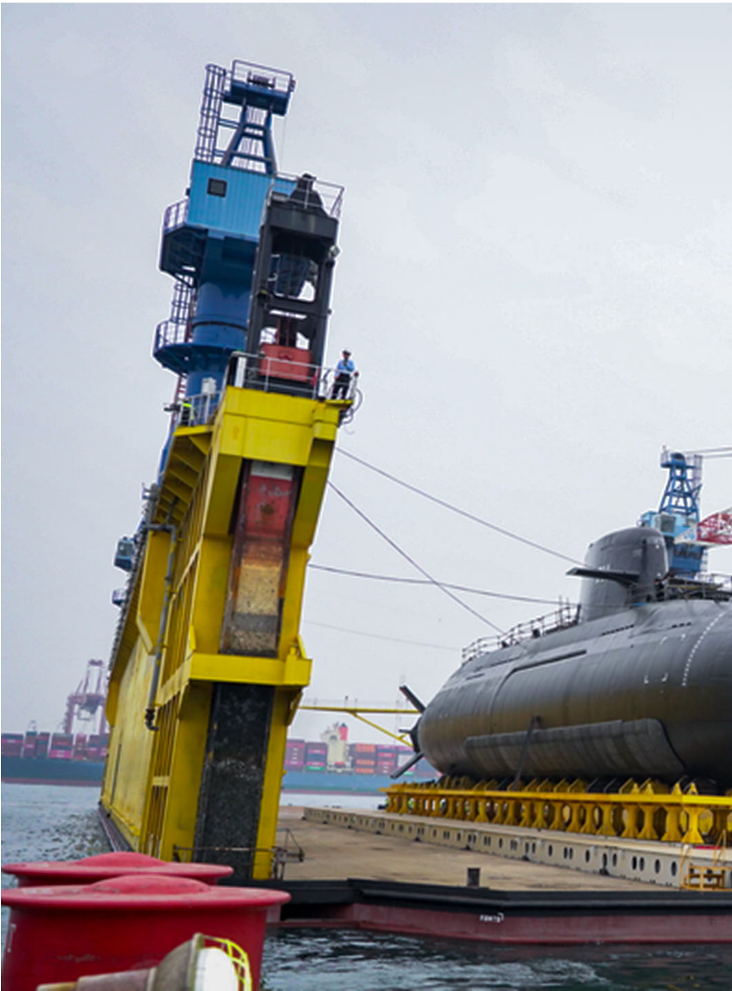
海鯤軍艦於浮塢就位備便浮船作業。圖：台船提供
